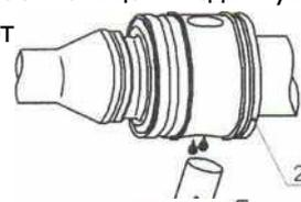
14. Снять с вала поджимную пружину торцевого уплотнения 1.
